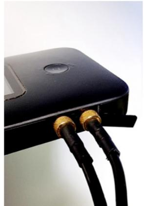
TS9-Anschlüsse lassen sich zum Entfernen einfach hineinschieben und herausziehen. Bitte achten Sie beim Anschließen oder Entfernen von extern montierten Antennenanschlüssen darauf, dass Sie dabei den Stecker selbst und nicht das Kabel anfassen, um mögliche Schäden an der Verkabelung zu vermeiden.
